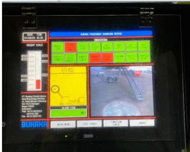
Gambar 4.3 Panel sensor aviobridge yang mengalami slowdown
